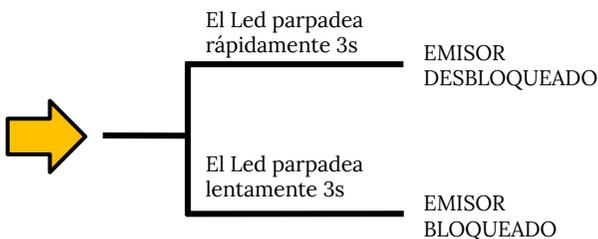
Anotación: Cuando el emisor está bloqueado, el motor no podrá ser operado por ninguna acción realizada en dicho emisor. El emisor viene desbloqueado de fábrica.
